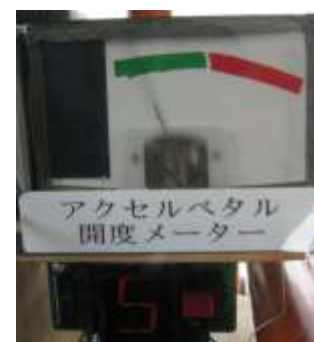
【アクセルペダル開度メーター】 運転者のアクセルの踏み込み加減を確認するメーター。教官席横に設置し、指導教官がペダルの踏み込みを確認できる。
