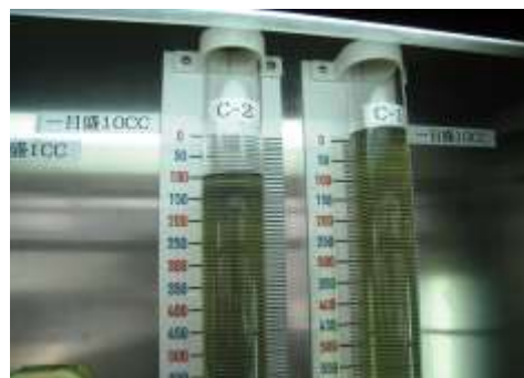
【使用燃料メスシリンダー】 2本のシリンダーを使い、通常運転時、エコ運転時それぞれの燃料使用量を視覚的に比較できる。
